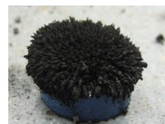
Vytavené železo vyrobené z oxidu železitého reaguje na magnet
