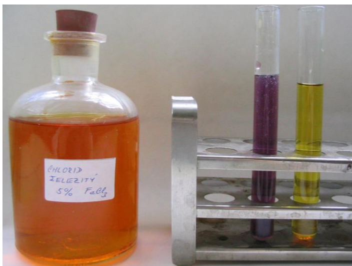
Reakce kyseliny salicylové a vyrobeného acylpyrinu s roztokem chloridu železitého (acylpyrin se nechová jako fenol)
