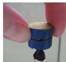
Vytavené železo vyrobené z oxidu železitého reaguje na magnet
