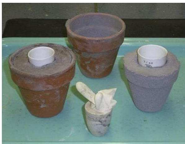
Příprava šamotové formy pro žíhací kelímek
