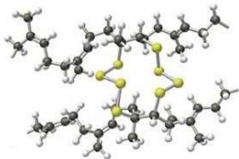
Obr. 4.3: Polysulfidické můstky ve struktuře umělého kaučuku
