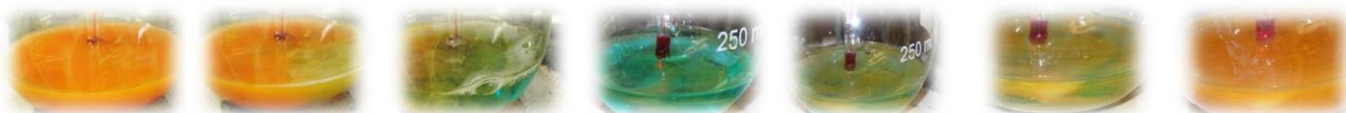
Obr. 103 - Barevné změny v reakční směsi v průběhu reakce při t mezi 50 – 70 °C
