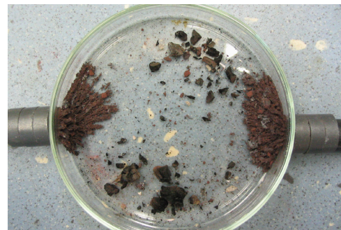
Vytavené železo vyrobené z oxidu železitého reaguje na magnet
