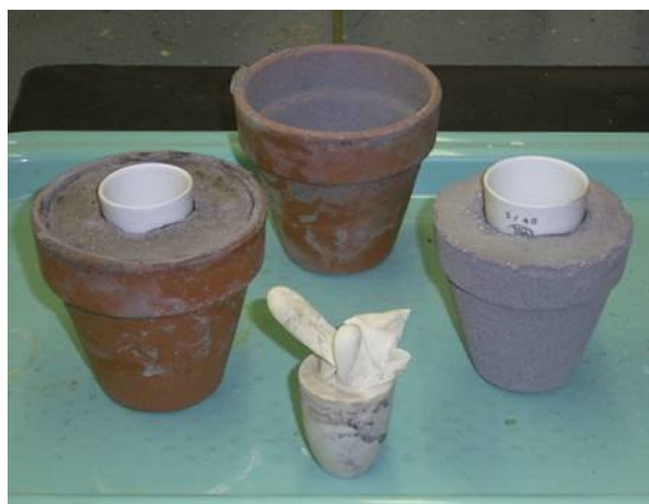
Příprava šamotové formy pro žíhací kelímek
