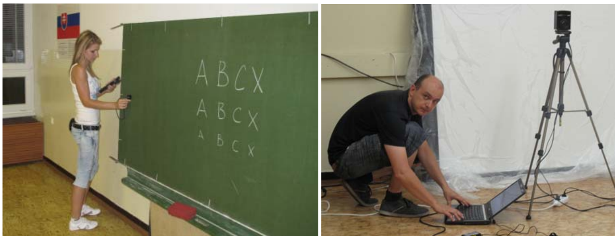
Obr. 16 Meranie intenzity osvetlenia (vľavo) a meranie jasovým analyzátorom (vpravo)
