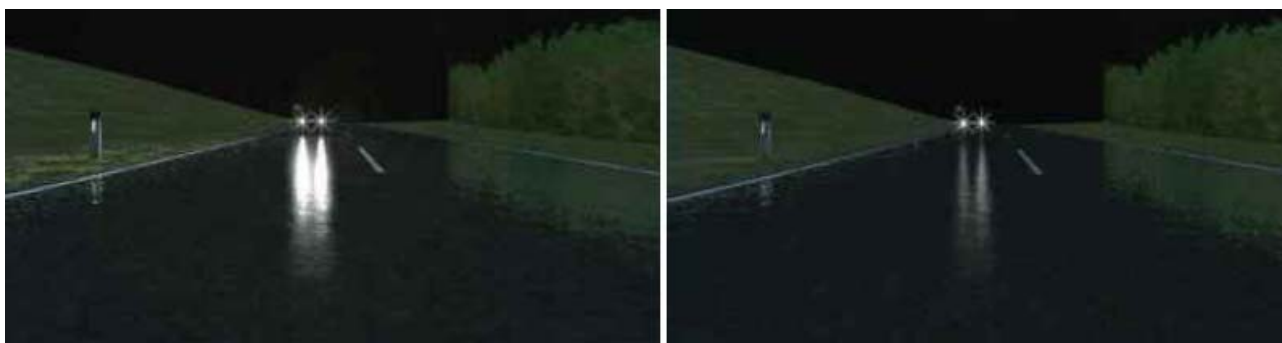
• obrázok 4: stretávacie svetlá v daždi (vľavo), svetlá do zlého počasia v daždi (vpravo) [3]
