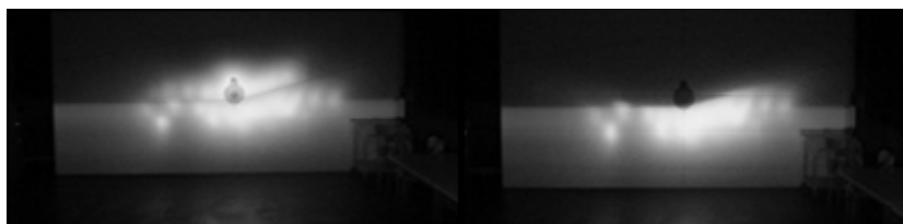
• obrázok 7: svetelný zväzok vytvorený Led poľom (vľavo diaľkové a vpravo tímené svetlo)
