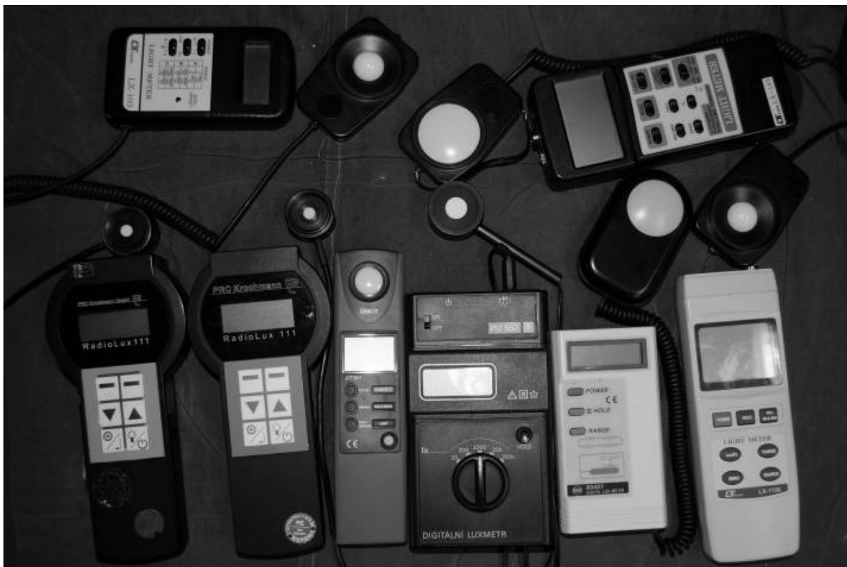
• obrázok 1: použité luxmetre s rôznou smerovou chybou f_2
