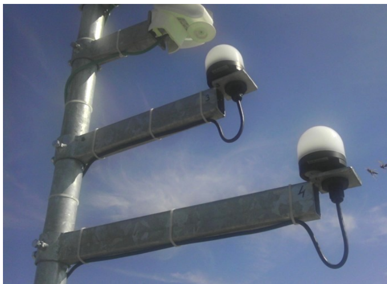
• obr. 2 čidla denní intenzity
