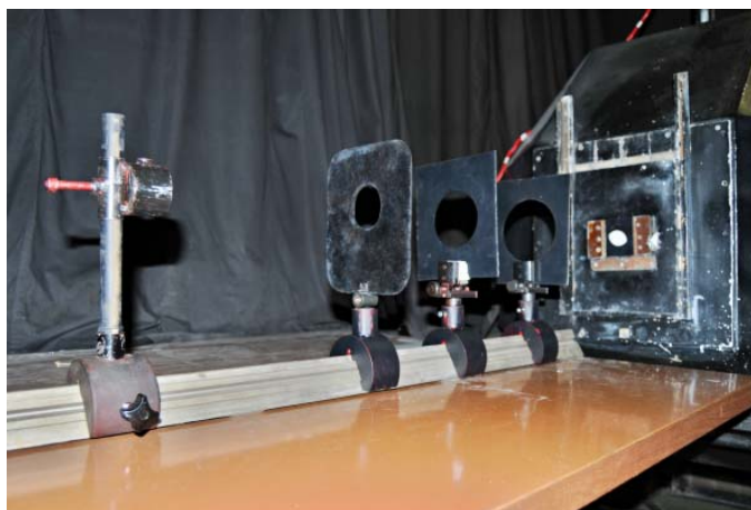
Obrázok 2: Zostavenie etalónu jasú pomocou fotometrického integrátora
