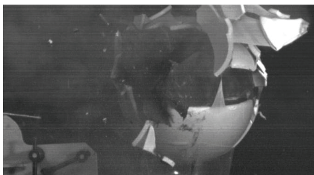
Obr. 4 Polyuretanová „lebka“ Synbone s trhlinami a masivním oblakem dýmu.
