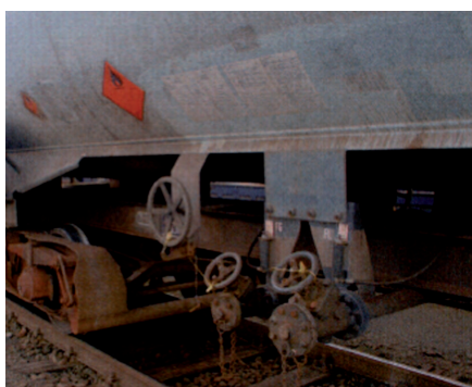
Obrázek 8a a 8b: Detailní pohled na armatury železniční cisterny – armatura pro odplynění DN 50 (levá armatura) a armatura pro stáčení DN 80 (pravá armatura) (Bernatík, 2006).
