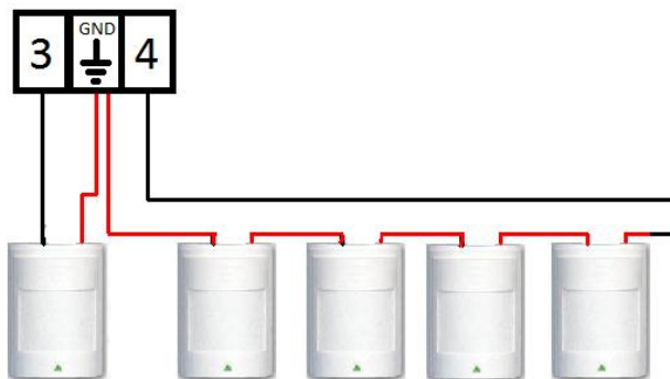
Obrázek 5: Zapojení externích detektorů typu NC.
