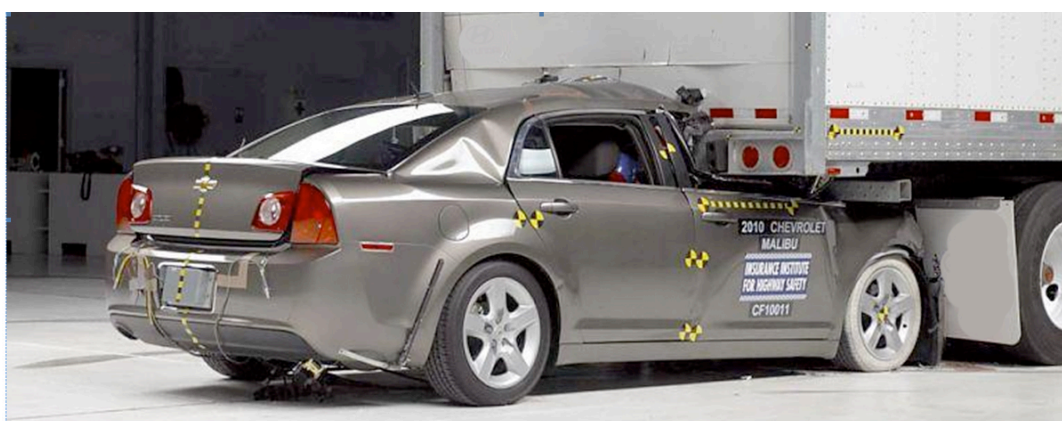
Obr. č. 16 Nesprávne umiestnenie ZOZPP s nedostatočnou pevnosťou na nákladnom vozidle.
