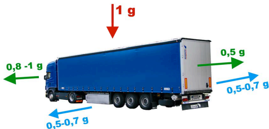
Obr. č. 8.1. Návrhové zrýchlenia pre upevnenie nákladu v cestnej nákladnej doprave.
