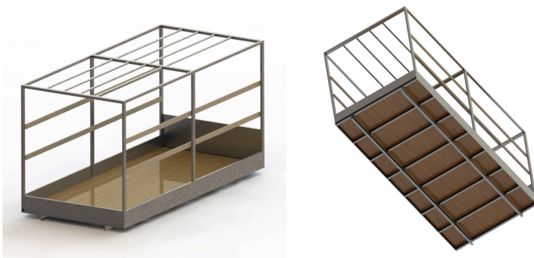
Obr. č. 13 3D model valníkovej nadstavby. Vypočítaná poloha výšky ťažiska skúmanej valníkovej nadstavby bola 680 mm.
