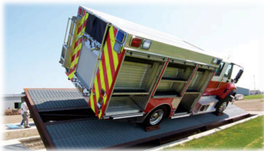
Obr. č. 12 Vozidlo pri teste priečnej stability.
