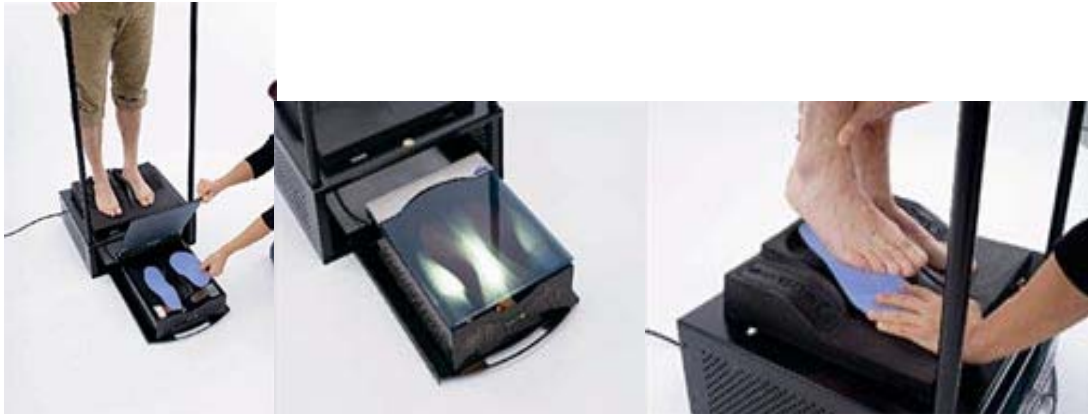
Obr.10-9 Tvarování vložky působením tepla
