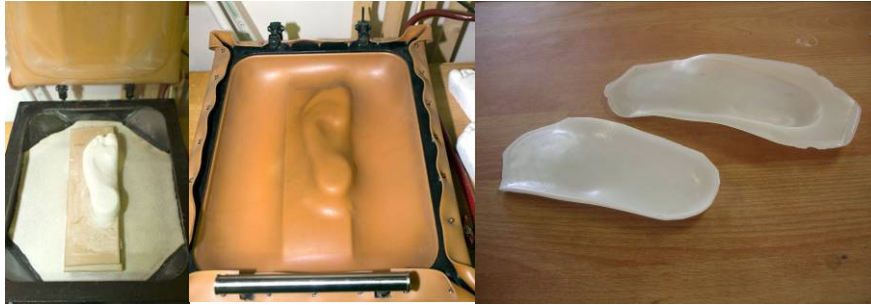
Obr.10-3 Tvarování vložky pomocí vývěvy
