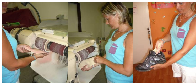
Obr.9-14 Úprava vložek broušením a zkoušení vložek do obuvi
