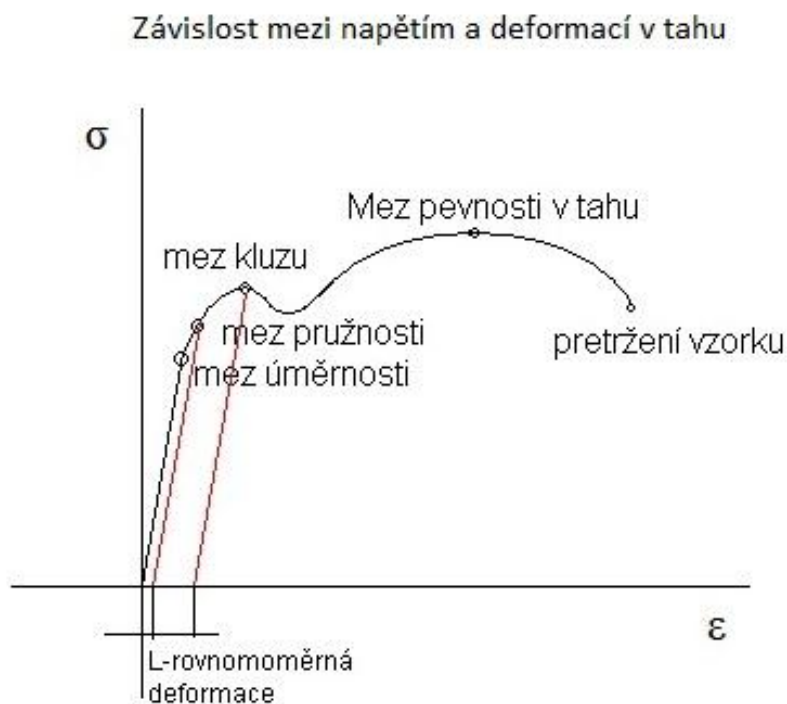
Obr. 7: Příklad pracovního diagramu nebiologických materiálů, např. oceli
