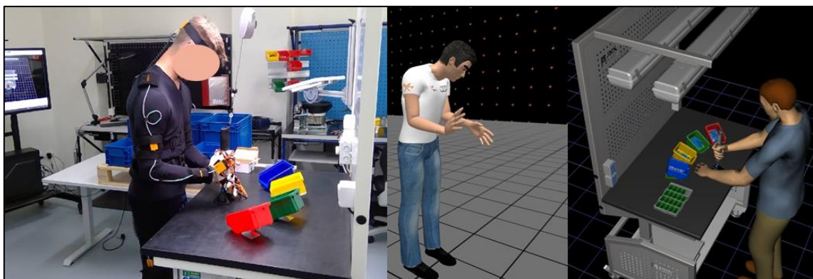
Obr. 5.17: Vybraná laboratorní úloha montáže (vlevo fyzická úloha, uprostřed s využitím Motion Capture, vpravo digitální dvojče v SW Siemens Tecnomatix Jack)
