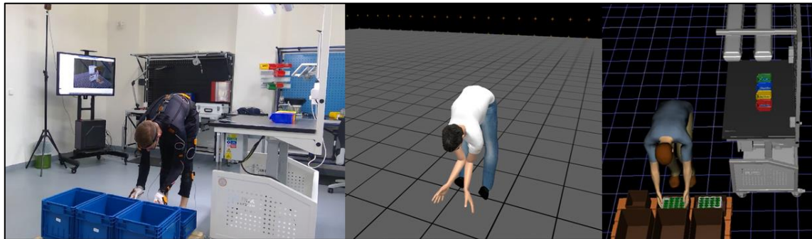
Obr. 5.14: Vybraná laboratorní úloha manipulace s břemeny (vlevo fyzická úloha, uprostřed s využitím Motion Capture, vpravo digitální dvojčete v SW Siemens Tecnomatix Jack)
