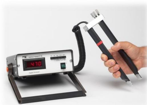
Obrázek 14: Ruční dynamometr (Zdroj: www.mie-uk.com )
