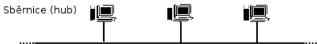
Obrázek 5.1: Sběrníková topologie počítačových sítí
