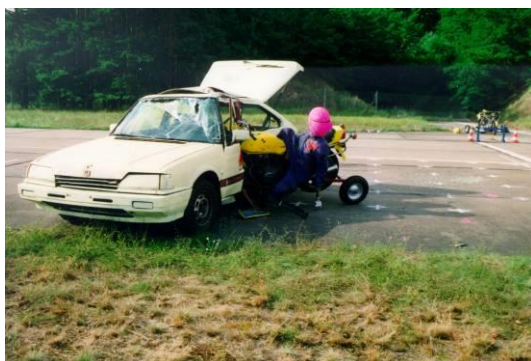
Obr. 6.1-18 - konečné postavení OA a motocyklu s dummy figurínou
