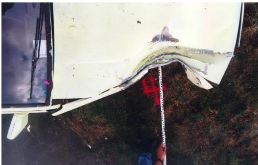
Obr. 6.1-13 - detail místa kolize na OA
