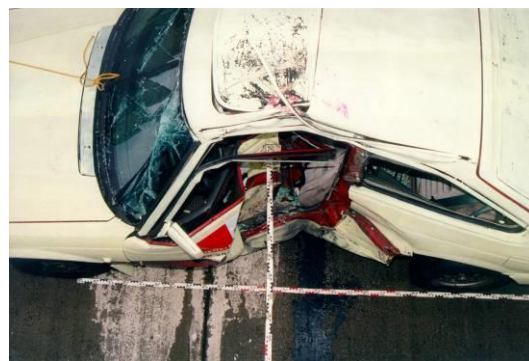
Obr. 6.1-19 - detail místa kolize na OA
