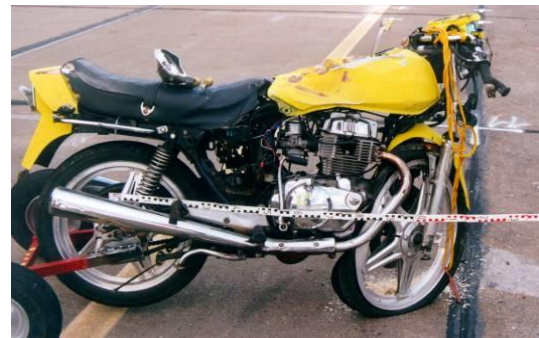
Obr. 6.1-14 - škody na motocyklu
