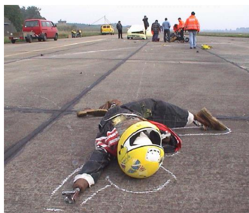
Obr. 6.1-5 – konečná polohy dummy figuríny
