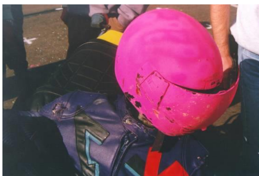
Obr. 6.1-20 – poškození přilby dummy figuríny
