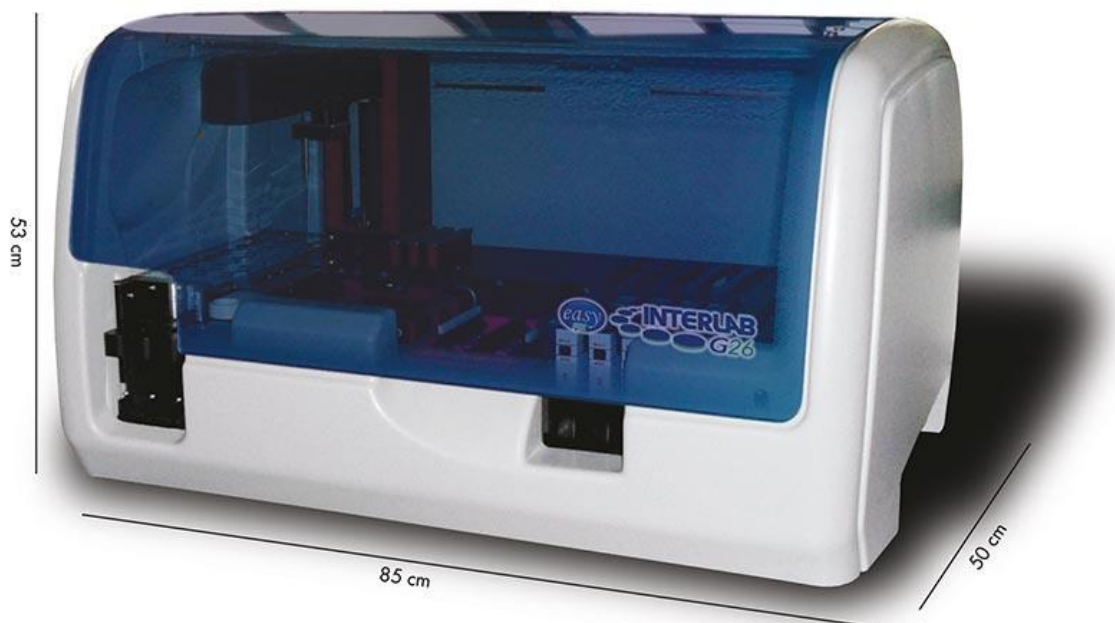
Obrázek 22 Analyzátor Interlab G26 Easy Fix (Interlab S.r.l. nedatováno)
