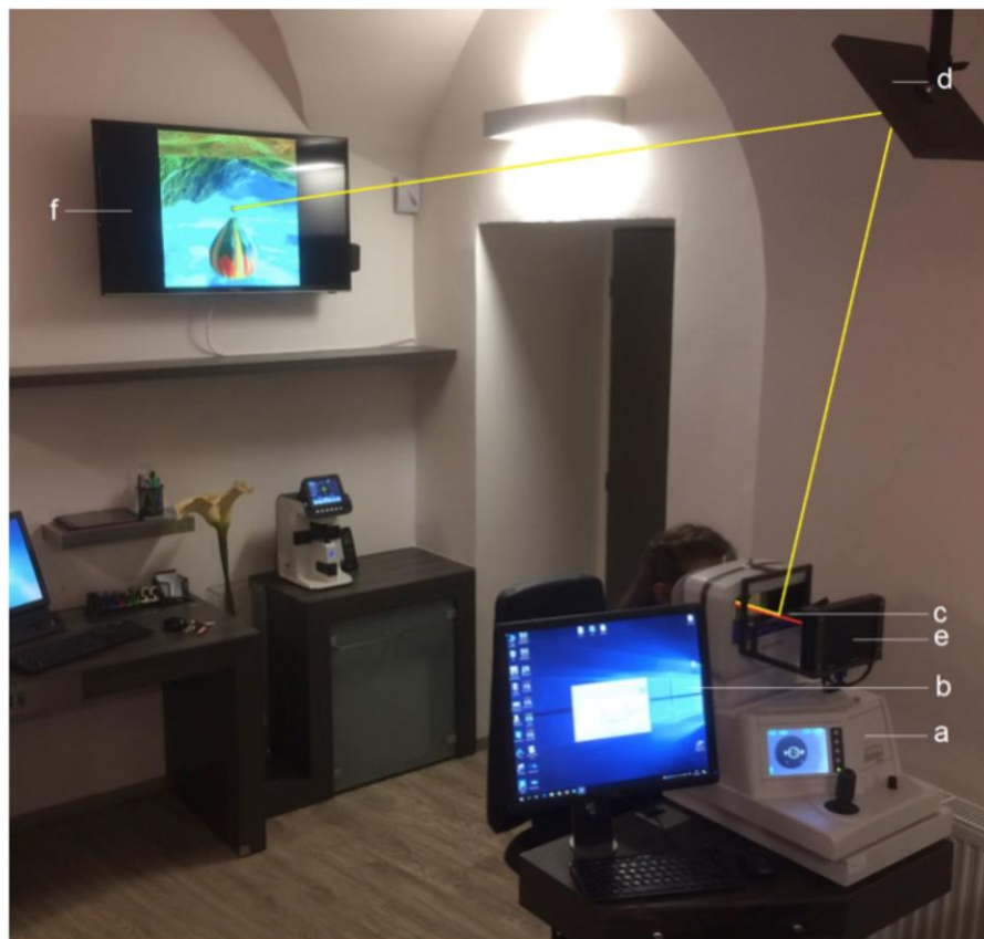
Obr. 3. Optické schéma pohledu na blízký fixační monitor (červená přímka) vzdálený fixační monitor (žlutá spojnice)
