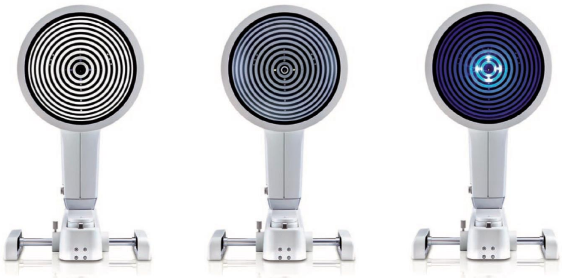
Obr. 36: OCULUS Keratograph M5; vlevo: bílé LED osvětlení, uprostřed: infračervené LED osvětlení, vpravo: modré LED osvětlení [73]
