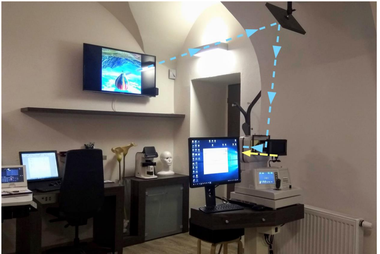
Obr 35: Experimentální akomodometr ve vyšetřovací místnosti, modře – trasovaný paprsek vzdáleného obrazu, žlutě – trasovaný paprsek blízkého obrazu; zdroj: archiv autora
