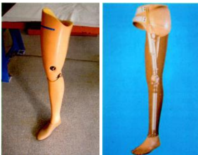
Obrázek 4. Vlevo exoskeletová a vpravo endoskeletová protéza dolní končetiny (Gallo, 2011).
