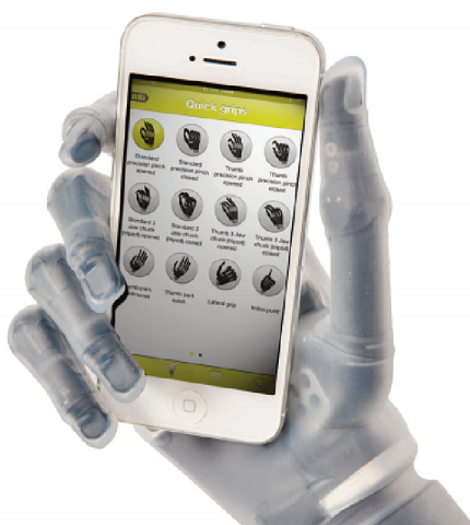
Obr. 2.7: Bionická protéza i-Limb Revolution a mobilní SW [13]
