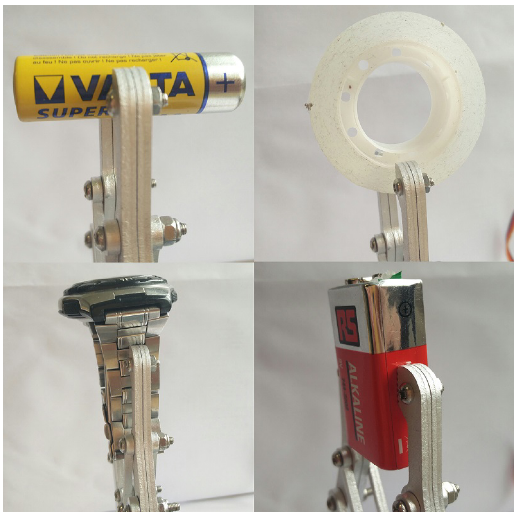
Obr. 6.3: Úchop baterie terminální pomůckou
