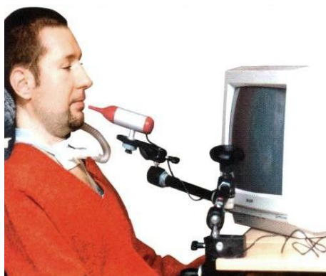
obr. 10: IntegraMouse – myš ovládaná ústy a dechem
