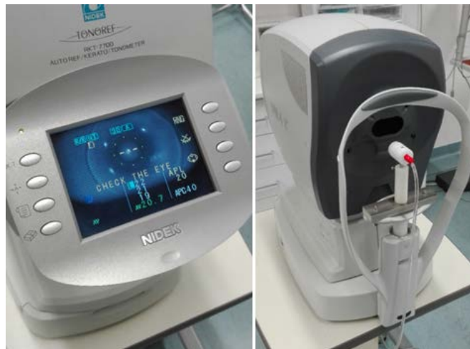
Obrázek 3: Přenosný etalon určený na kalibraci očních tonometrů – měření na bezkontaktním tonometru NIDEK. [7]
