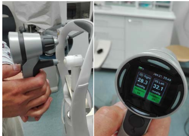
Obrázek 2: Přenosný etalon určený na kalibraci očních tonometrů – měření na kontaktním (aplačním) tonometru. [7]
