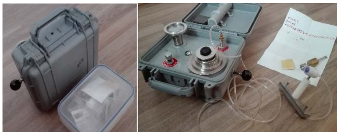
Obrázek 1: Přenosný etalon určený na kalibraci očních tonometrů. [7]
