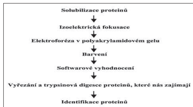
Obrázek č. 1: Schéma návaznosti jednotlivých kroků proteomické analýzy (2D-PAGE/MS)
