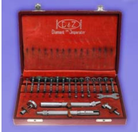
Diamant Imperator firmy D & Z (Drendel & Zweiling) založené v r. 1920 v Berlíně. Specializovala se na diamantové brusky. Zobrazený soubor je velice dobře a téměř kompletně zachovaný (kolem r. 1930).
