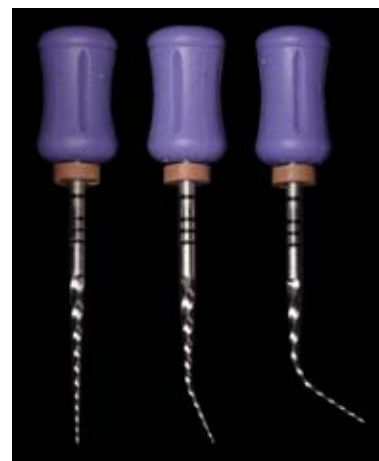
Obr. 4: Ruční nikltitanový nástroj ProTaper Universal S1 bez předehtnutí (vlevo), po předehtnutí (uprostřed), po předehtnutí a zchlazení (vpravo).
