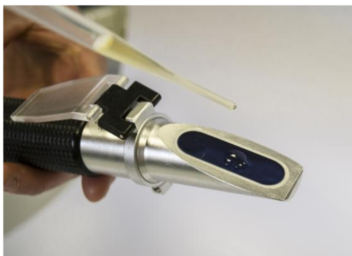
Obrázek 27 – Optický refraktometr pro hodnocení CB ze séra pro hodnocení kvality kolostrální imunity u telat
