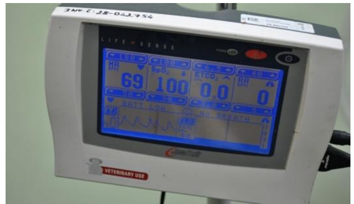
Obrázek 52 – Oxymetr pro měření saturace krve kyslíkem (SpO 2 )
