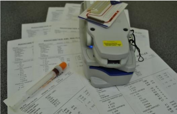
Obrázek 53 – Přenosný přístroj pro měření acido-basické rovnováhy
